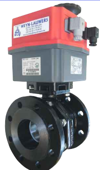
KUNSTSTOF motor dubbelwerkend nodulair gietijzer - volle doorlaat - PN16 S-serie : 24-230 VAC/DC L-serie : 12-84 VAC/DC H-serie : 84-240 V 2 instelbare eindschakelaars DN15 - DN100 : PN16 fig 151 JJ : DN15 - DN100 geflensd
