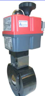
staal - KUNSTSTOF motor dubbelwerkend volle doorlaat - PN16/40 - wafer-type S-serie : 24-230 VAC/DC L-serie : 12-84 VAC/DC H-serie : 84-240 V 2 instelbare eindschakelaars DN15 - DN50 : PN40 DN65 - DN100 : PN16 fig 181.3 JJ : DN15 - DN100 geflensd
