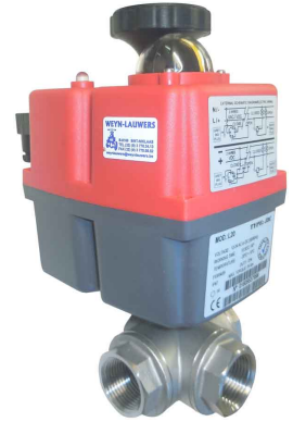
RVS - KUNSTSTOF motor dubbelwerkend 3-weg-gereduceerde doorlaat - bsp S-serie : 24-230 VAC/DC L-serie : 12-84 VAC/DC H-serie : 84-240 V 2 instelbare eindschakelaars fig 186 JJ S : PN63 1/4"-2 1/2" bsp fig 187 JJ S : PN63 1/4"-2 1/2" bsp
