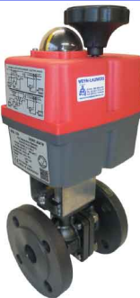
staal - KUNSTSTOF motor dubbelwerkend volle doorlaat - PN16/40 - wafer-type S-serie : 24-230 VAC/DC L-serie : 12-84 VAC/DC H-serie : 84-240 V 2 instelbare eindschakelaars DN15 - DN50 : PN40 DN65 - DN100 : PN16 fig 164 JJ : DN15 - DN100 geflensd
