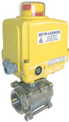
RVS - ALUMINIUM motor dubbelwerkend 3-delig - volle doorlaat - bsp draadeinden 230VAC - 24VDC/AC - 12VDC 2 instelbare eindschakelaars nood handbediening fig 177SA : PN63 1/4"-2" bsp fig 177NA : PN63 2 1/2"-4" bsp
