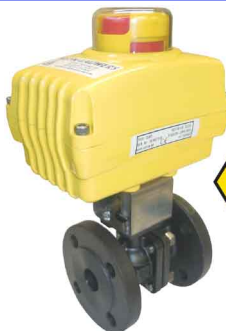
staal - ALUMINIUM motor dubbelwerkend volle doorlaat - PN16/40 - wafer-type 230VAC - 24VDC/AC - 12VDC 2 instelbare eindschakelaars nood handbediening DN15 - DN50 : PN40 DN65 - DN200 : PN16 fig 164 SA/NA : DN15 - DN200 geflensd
