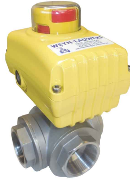
RVS - ALUMINIUM motor dubbelwerkend 3-weg-gereduceerde doorlaat - bsp 230VAC - 24VDC/AC - 12VDC 2 instelbare eindschakelaars nood handbediening fig 186 SA/NA : PN63 1/4"-2 1/2" bsp fig 187 SA/NA : PN63 1/4"-2 1/2" bsp
