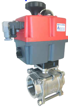
RVS - KUNSTSTOF motor dubbelwerkend 3-delig - volle doorlaat - bsp draadeinden S-serie : 24-230 VAC/DC L-serie : 12-84 VAC/DC H-serie : 84-240 V 2 instelbare eindschakelaars fig 177JJ S : PN63 1/4"-2 1/2" bsp fig 177JJ L/H : PN63 3"-4" bsp
