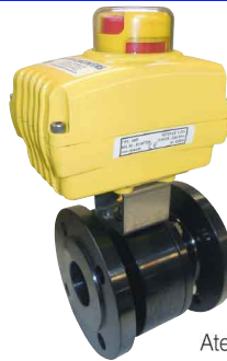
staal - ALUMINIUM motor dubbelwerkend volle doorlaat - PN16/40 - wafer-type 230VAC - 24VDC/AC - 12VDC 2 instelbare eindschakelaars nood handbediening DVGW : DN15 tot DN100 fig 163 SA/NA : DN15 - DN200 geflensd
