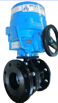
ALUMINIUM motor dubbelwerkend nodulair gietijzer - volle doorlaat - PN16 230VAC - 24VDC/AC - 12VDC 2 instelbare eindschakelaars nood handbediening DN15 - DN200 : PN16 fig 151 SA/NA : DN15 - DN200 geflensd
