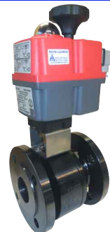
staal - KUNSTSTOF motor dubbelwerkend volle doorlaat - PN16/40 - wafer-type S-serie : 24-230 VAC/DC L-serie : 12-84 VAC/DC H-serie : 84-240 V 2 instelbare eindschakelaars fig 163 JJ : DN15 - DN100 geflensd
