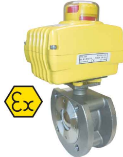
RVS - ALUMINIUM motor dubbelwerkend volle doorlaat - PN16/40 - wafer-type 230VAC - 24VDC/AC - 12VDC 2 instelbare eindschakelaars nood handbediening DN15 - DN50 : PN40 DN65 - DN200 : PN16 fig 181.3 SA/NA : DN15 - DN200 geflensd
