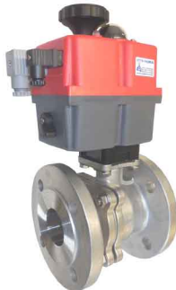
RVS - KUNSTSTOF motor dubbelwerkend 2-delig - volle doorlaat S-serie : 24-230 VAC/DC L-serie : 12-84 VAC/DC H-serie : 84-240 V 2 instelbare eindschakelaars DN15 - DN50 : PN40 DN65 - DN100 : PN16 fig 175 JJ : DN15 - DN100 geflensd
