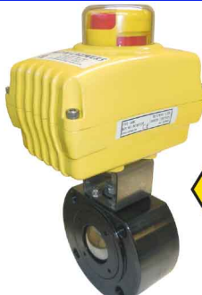
staal - ALUMINIUM motor dubbelwerkend volle doorlaat - PN16/40 - wafer-type 230VAC - 24VDC/AC - 12VDC 2 instelbare eindschakelaars nood handbediening DN15 - DN50 : PN40 DN65 - DN200 : PN16 fig 181.3 SA/NA : DN15 - DN200 geflensd
