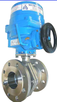
RVS - ALUMINIUM motor dubbelwerkend 2-delig - volle doorlaat 230VAC - 24VDC/AC - 12VDC 2 instelbare eindschakelaars nood handbediening DN15 - DN50 : PN40 DN65 - DN200 : PN16 fig 175 SA/NA : DN15 - DN200 geflensd
